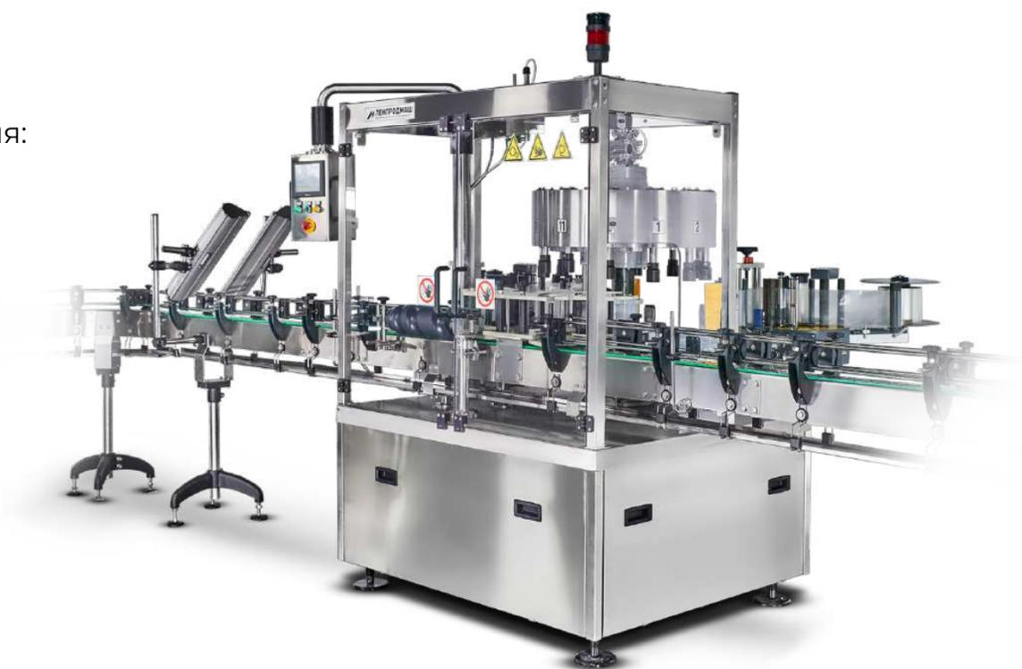
Приводные валы шнека и турникетных звездочек оснащены предохранительными муфтами предельного момента, которые оборудованы датчиками, останавливающими машину в случае заклинивания тары в турникетной группе. Принцип работы машины - "Нет бутылки - Нет нанесения этикетки".
